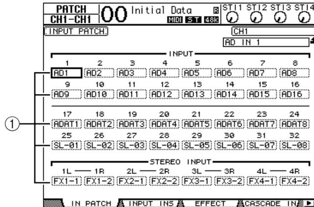
Les entrées et canaux de Slot actuellement assignés aux canaux d'entrée sont indiqués dans les boîtes de paramètres (①) en dessous des numéros des canaux. Voici le sens des indicateurs de paramètre:
