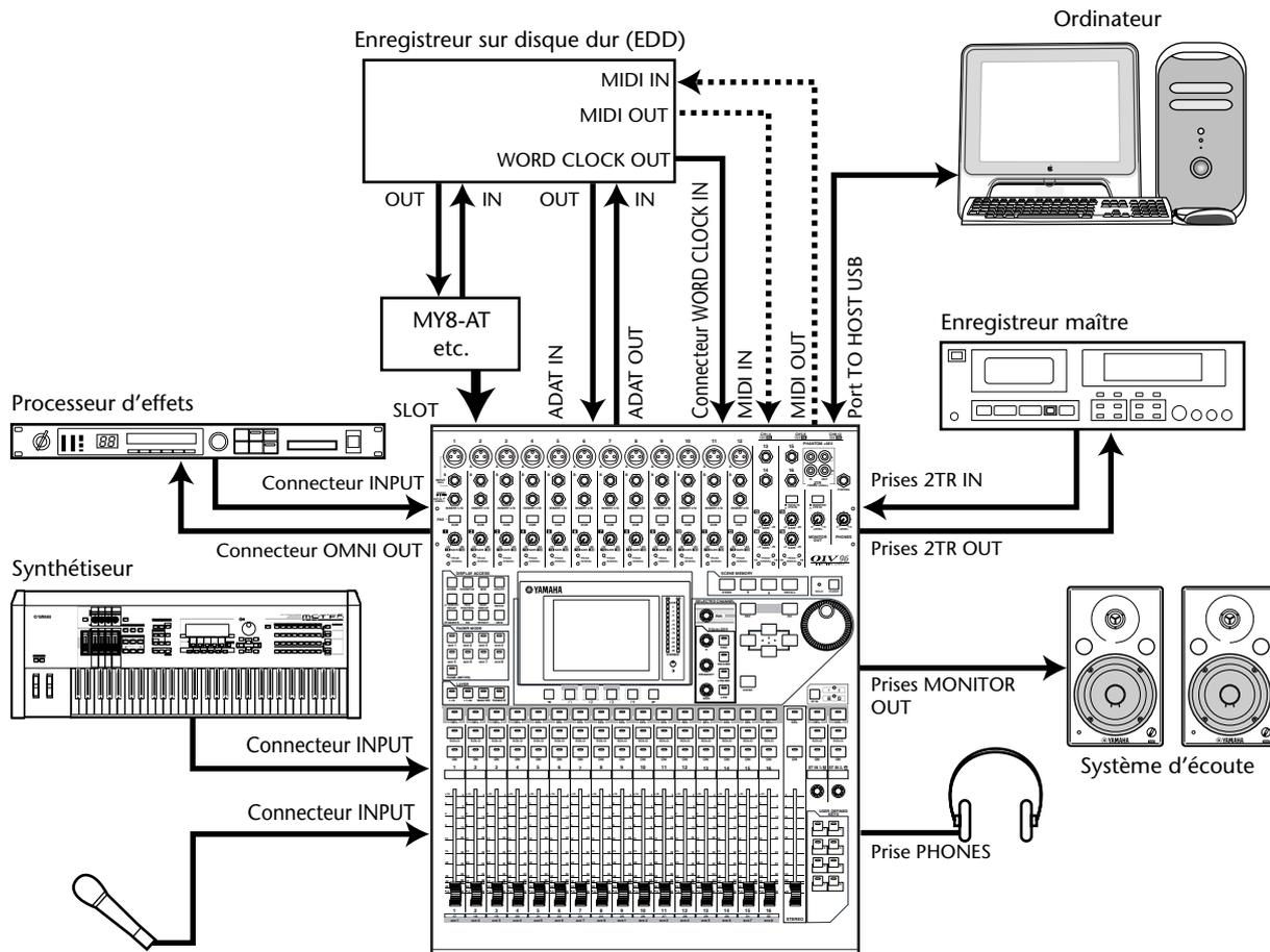
Ici, la 01V96 fait partie d'un système comprenant un EMP (enregistreur multipiste), à disque dur par exemple, relié aux prises ADAT IN et OUT de la 01V96 ainsi qu'à une carte E/S optionnelle (MY8-AT, MY16-AT, MY8-TD, etc.) logée dans la fente. Ce système permet l'enregistrement de pistes, les ajouts et la fusion de pistes ainsi que le mixage final. Vous pouvez en outre piloter la section de transport de l'EDD en lui envoyant des commandes MMC à partir de la 01V96.
