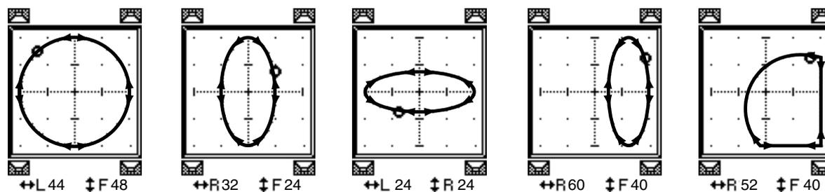
**4** En cas de besoin, précisez la trajectoire en modifiant les valeurs des paramètres WIDTH, DEPTH, OFFSET (↕) et OFFSET (↔).
