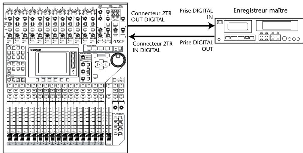
**Astuce:** Vous pourriez aussi relier les sorties analogiques de l’enregistreur maître aux prises 2TR IN de la 01V96. Cela vous permettrait en effet d’alterner entre les signaux internes et ceux de la machine de mastérisation. Les deux peuvent en effet être transmis aux prises MONITOR OUT.
