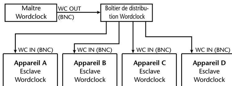
Si les appareils externes ne possèdent pas d'entrée ni de sortie Wordclock, vous pouvez utiliser les données de synchronisation incluses dans les signaux audio numériques. Dans ce cas, les signaux audio numériques et les signaux Wordclock sont transmis et reçus via les prises 2TR OUT DIGITAL et 2TR IN DIGITAL ou par le biais d'une carte E/S installée dans la fente en face arrière.
