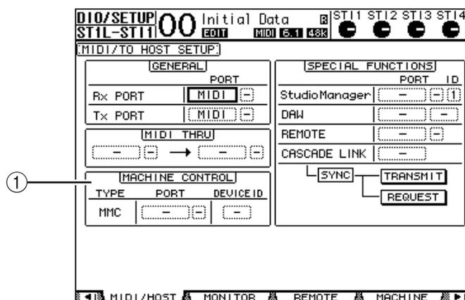
**3 Amenez le curseur sur la boîte de paramètre PORT de la section MACHINE CONTROL (①) et choisissez la destination MMC avec la molette de paramètre.**
