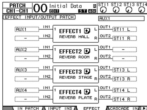
Cette page permet d'assigner les entrées et sorties des processeurs d'effets 1–4. Par défaut, le bus AUX 1 est relié au processeur d'effets 1. Les sorties de ce dernier sont acheminées vers le canal ST IN 1 (L et R). Voyez l'illustration plus haut.
