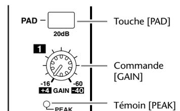
**Astuce:** Les commandes [GAIN] règlent la sensibilité d'entrée dans le domaine analogique. En vue d'un rapport signal/bruit optimal, avec un maximum de signal et un minimum de souffle, vous devez régler les commandes [GAIN] à la valeur la plus élevée, tout en prenant soin d'éviter la saturation.
