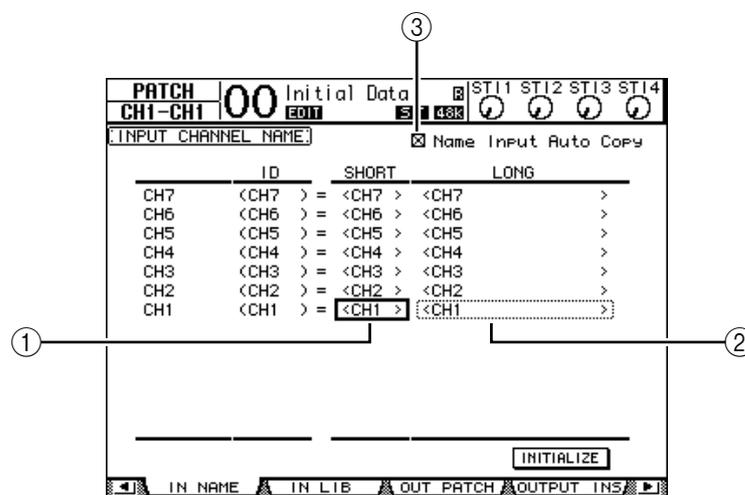
Cette page affiche de gauche à droite l'identité (ID) des canaux, leur nom abrégé (Short) et leur nom complet (Long). Vous pouvez entrer un nom abrégé dans les boîtes de paramètre de la colonne centrale (①) et un nom complet dans les boîtes de paramètre de la colonne de droite (②).
