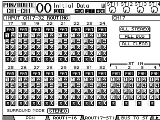
Les canaux d'entrée 17–32, qui reçoivent les signaux des pistes 1–16, sont maintenant reliés au bus stéréo et transmis aux prises STEREO OUT et 2TR OUT DIGITAL.
