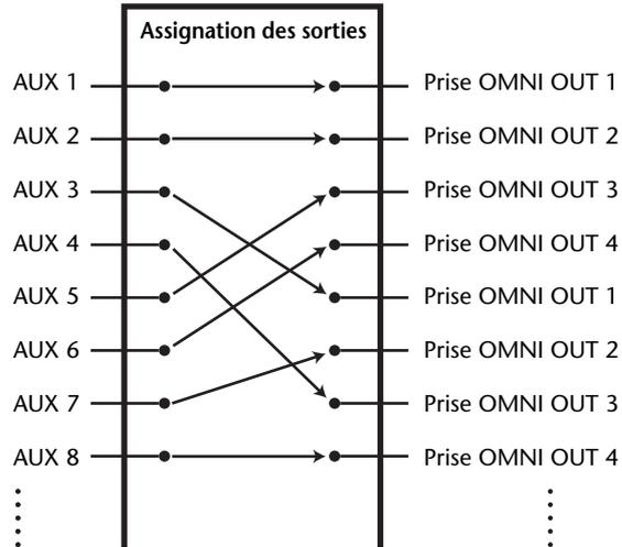
Par défaut, les routages suivants sont attribués aux sorties et aux canaux de sortie ADAT OUT et Slot:
