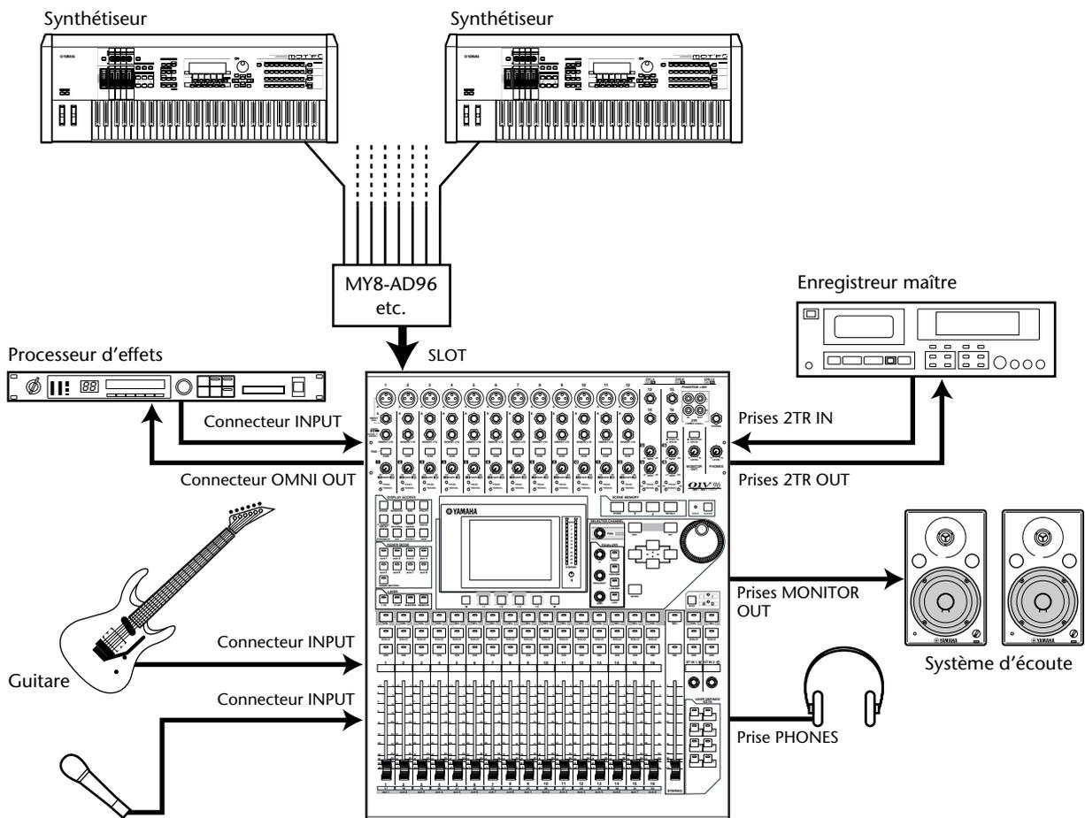
Dans ce système, la 01V96, dotée d'une carte AD en option (MY8-AD, MY8-AD96, etc.) dans sa fente, sert de console pour claviers ou de console de sonorisation. Vous disposez en tout de 24 canaux analogiques, y compris les entrées 1–16 et les entrées de la carte AD pour vos travaux de mixage.
