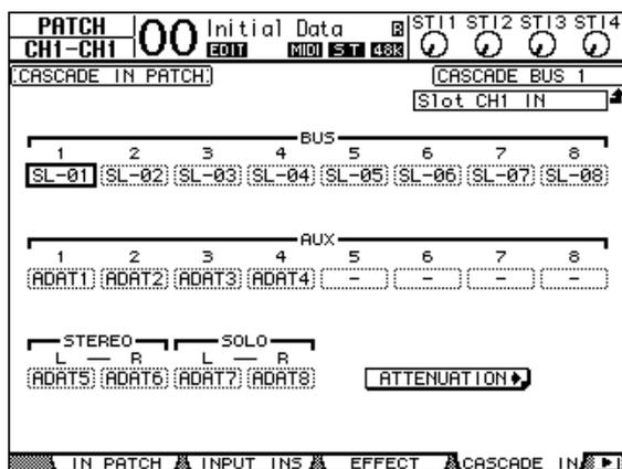
**Remarque:** Veillez à assigner les signaux des bus de la console esclave aux mêmes bus de la console maître. Toute erreur d'assignation compromettra le fonctionnement de la connexion en cascade.
